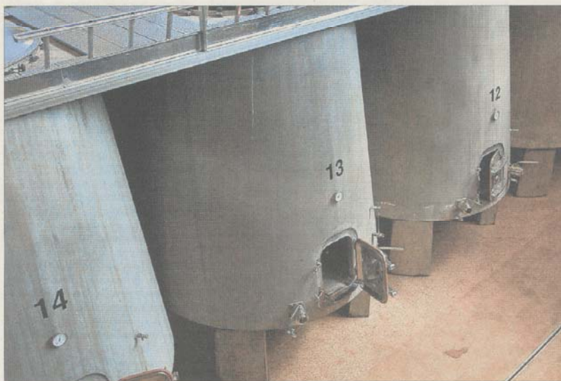
Depósitos troncocónicos de hormigón sin revestir para la elaboración de parte de los vinos de la bodega. Debajo, detalle del nuevo centro de enoturismo y de parte de las instalaciones de la bodega.
